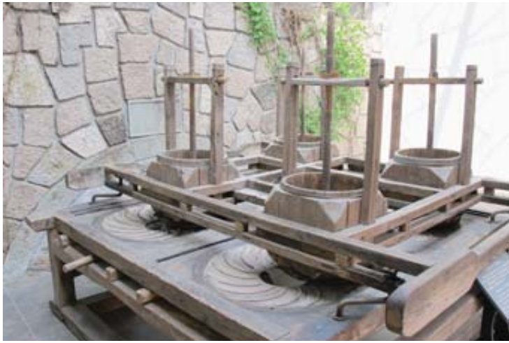
Comme un air de famille entre cet appareil à tordre les feuilles de thé et un vieux pressoir à raisins de chez nous.
